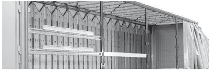
Verzinkte Stahlschlitzprofile für Teil-Beladung
