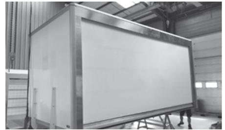
Leichter Aluminium Rahmen für reduziertes Eigengewicht
