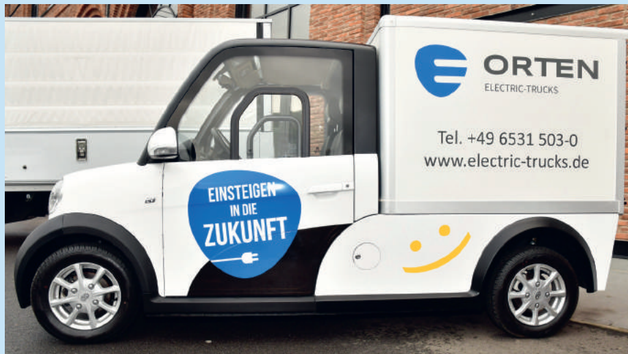
Umgerüsteter Elektro-Kleintransporter für den Lebensmitteltransport
