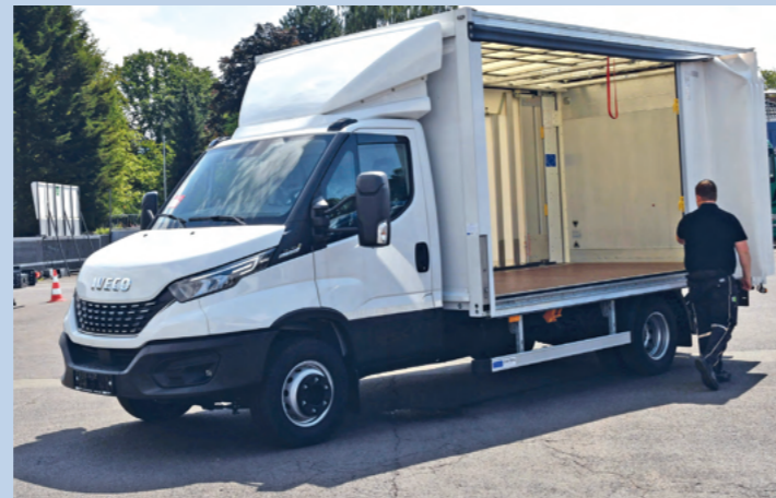
Für den Einsatz in der Innenstadt: City-Lifter-Schiebeplanenaufbau
