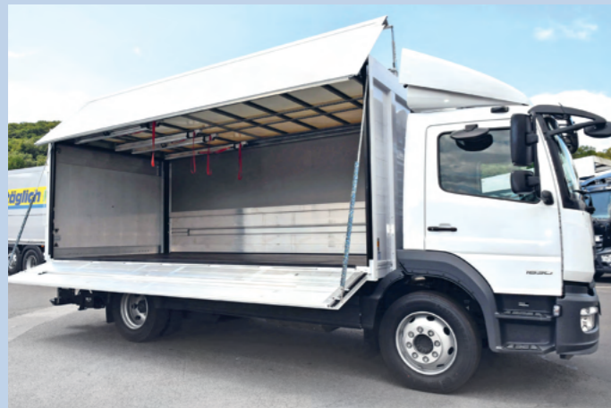
Flexible Lösung für den Getränke-transport: Kett-Liner-Aufbau von Orten
