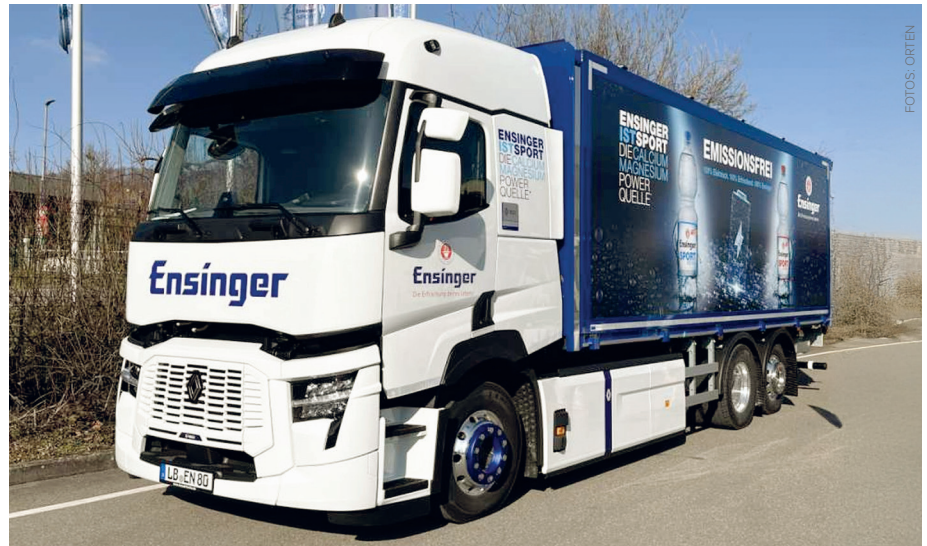
Ein spannendes Projekt: ein vollelektrisch zu öffnender ORTEN Sideliner-Aufbau mit Bär Ladebordwand auf einem 3-achsigen Renault E-Tech für den Kunden Ensinger Mineral-Heilquellen.
